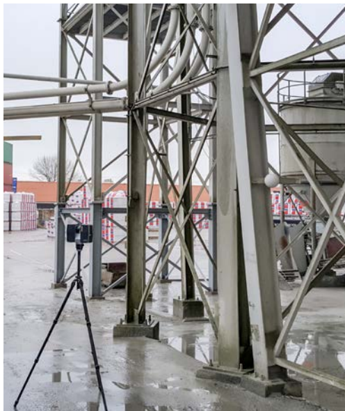
Snelle scanservice op locatie met FARO Focus laserscanner om 3D-modellen te creëren
