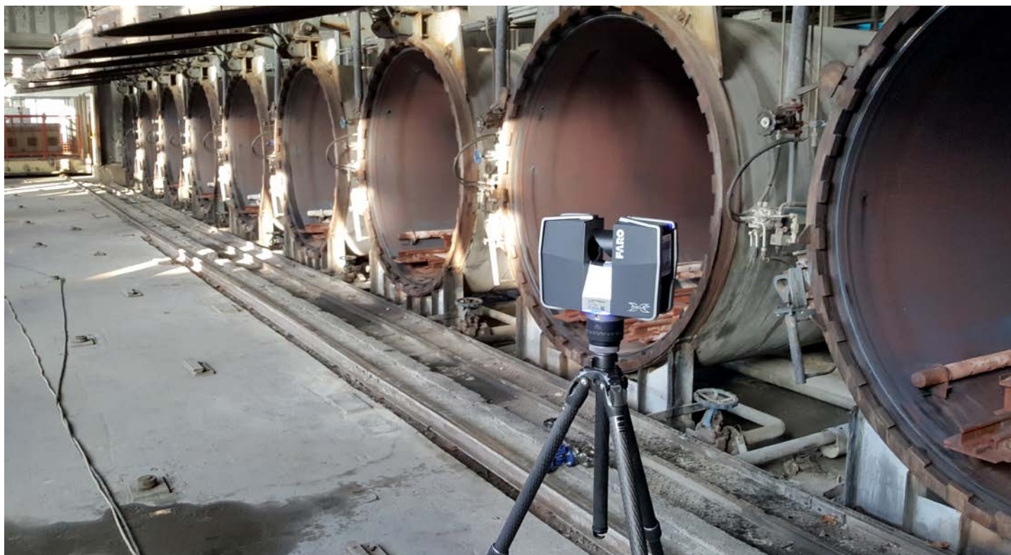
Scannen met de FARO Focus laserscanner om volledige en zeer nauwkeurige puntenwolken en 3D-modellen te verkrijgen
